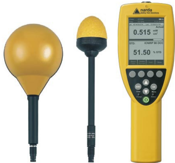
Equipo y sondas de medida de campos electromagnéticos
